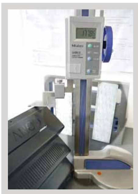
Komplettes Vermessen des Modells vor Auslieferung und Erstellung eines Erstmusterprüfberichts (auf Kundenwunsch)
